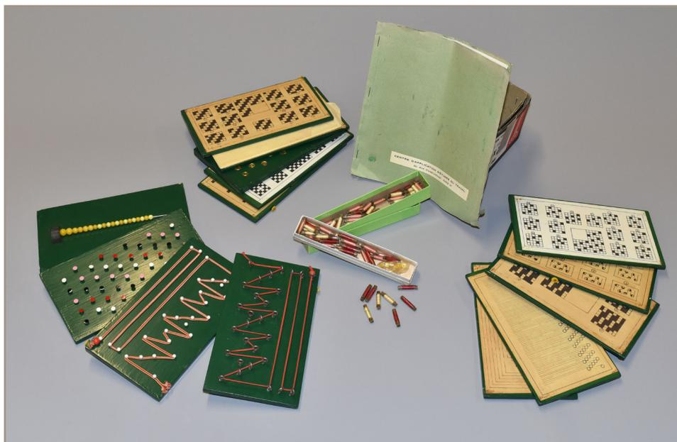
**Figure 6 - Outils d'apprentissage du « Centre d'application d'études du travail » : cahier de tests textiles, 15 planches de méthodologies, échantillons de petites bobines de fils. 1973.**
